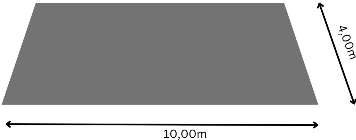
Bühne misst 10x4m, besteht aus 4x5 Einzelementen (Maße 1x2m).
